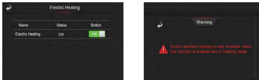
Figure 9 - Menu para Ativar Resistência Elétrica
